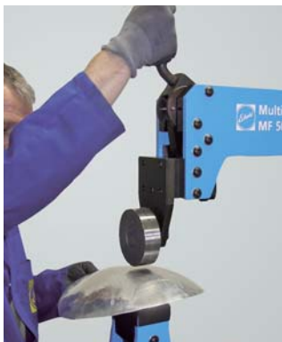
Schnellspannmechanismus zum Spannen der Bauteile. Quick-release mechanism to clamp and release the part.
