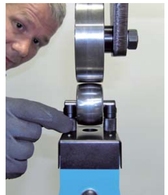
Optimale Justierung der Formrollen. Optimum setting of anvils.
