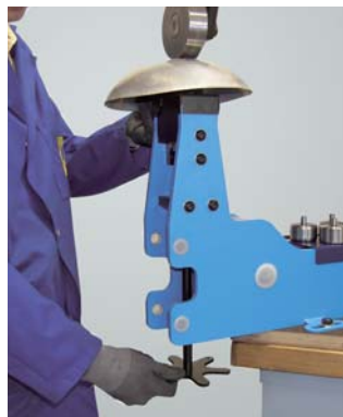
Spindelrad zur Regulierung des Arbeitsdruckes. Fine feeling setting of working pressure.
