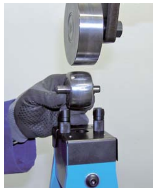
Schnellwechsel der Formrollen. Quick change of anvils.
